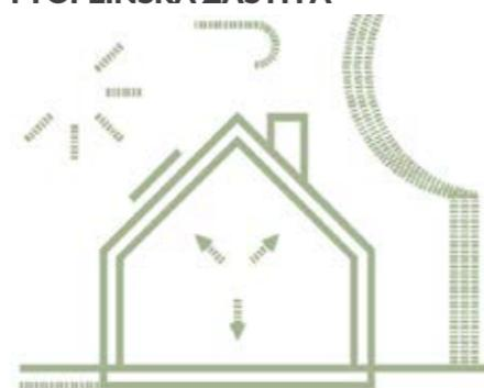
Arhitektonsko-građevinske karakteristike zgrade koje utječu na potrebnu energiju za grijanje i hlađenje jesu: kvaliteta ovojnica zgrade (debljine toplinske izolacije i vrsta ostakljenja), oblik zgrade (kompaktnost), orientacija otvora prema stranama svijeta i zaštita od sunca.
