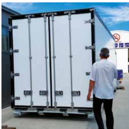
FIBRANxps FABRIC kao toplinska izolacija transportnih i stambenih kontejnera.
